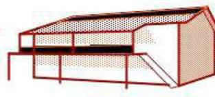
ou d'auvent (dessin ci-dessous), ou encore être posés au sol, ou d'ombrière au-dessus d'un stationnement. Pour éviter le mitage des couvertures, il est conseillé de les regrouper en une seule nappe rectangulaire, ou une bande horizontale ou verticale suivant le rythme de la façade et l'architecture du toit ou à leur donner un aspect de « tabatière » (chassis de toit ayant la même pente que le toit).
